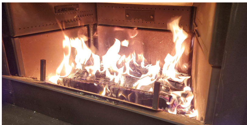
Figure 18 : Image de la flamme lors du chargement de la charge de la phase feu vif.
