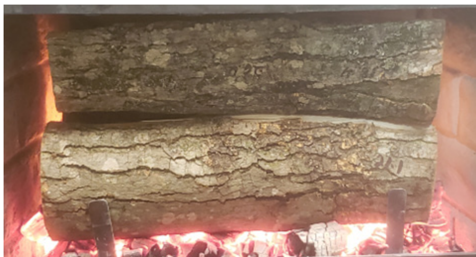
Figure 30: Phase de faible taux de combustion dans la chambre à combustion.
