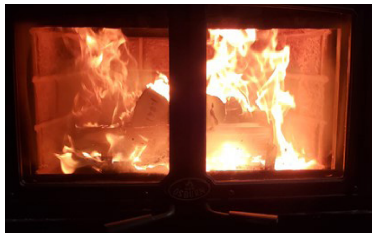
Figure 18: Intensité des flammes au début de la phase de démarrage (porte entrouverte d'environ 1 pouce)
