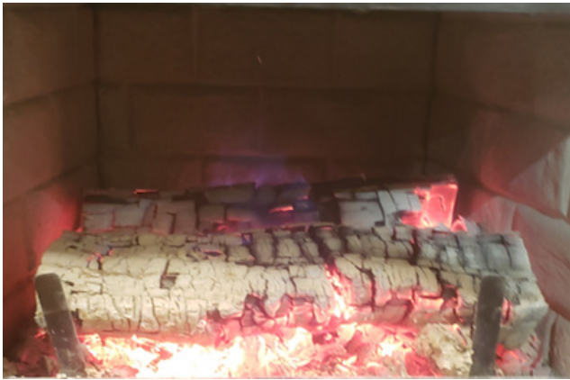
Figure 28: Lit de braise à la fin de la phase maintenance-feu
