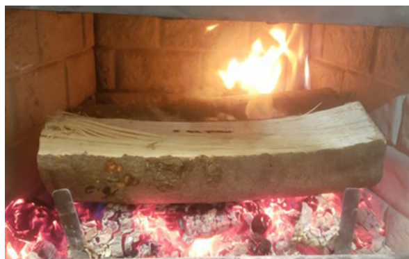
Figure 25: Charge de maintenance-feu dans la chambre à combustion.
