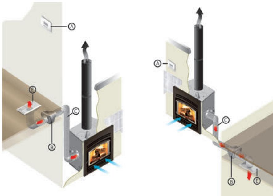
Le système peut aussi être utilisé comme chauffage d'appoint dans une pièce éloignée du foyer. Pour ce type d'application, il suffit de positionner le thermostat dans la pièce à chauffer et sélectionner la température devant être maintenue. Le système sera alors en mode « chauffage » et son puissant ventilateur sera actionné tant que la pièce éloignée n'aura pas atteint la température voulue et que le foyer sera suffisamment chaud pour distribuer sa chaleur.
