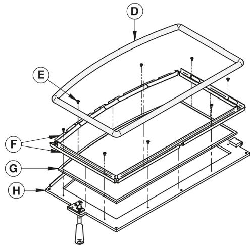
*Les deux principales causes de bris de vitre sont un placement inégal de la vitre dans la porte et un serrage excessif des vis.*
