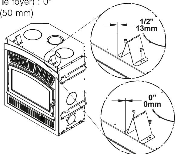
**Ne pas utiliser de matériaux combustibles pour le châssis situé directement au-dessus du foyer. Cette zone doit rester vide sur une hauteur de 80" (2,03 m) à partir de la base du foyer.**
