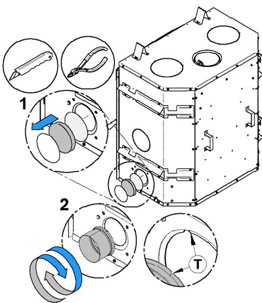
Figure 15: Entrée d'air du côté droit du foyer
