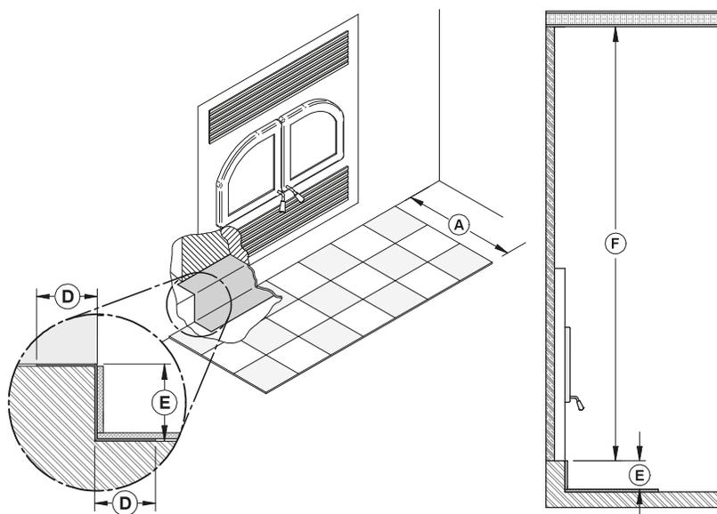
Lorsque le foyer est installé sur une base surélevée de 4" ou moins (**E**), une protection de plancher incombustible d'au moins 16" (**A**) avec un facteur R de 1.00 doit être installée en face du foyer.
