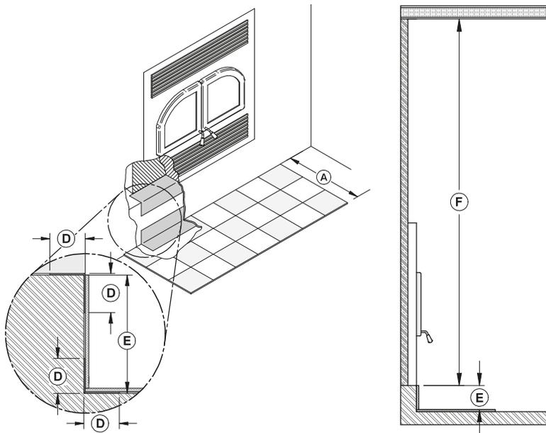
Lorsque le foyer est installé sur une base surélevée de plus de 4" (E), une protection de plancher incombustible d'au moins 16" (A), sans facteur R doit être installée en face du foyer.
