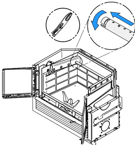
2. Aligner le chemin du tube et la dent dans le trou de la canalisation. Tenir le tube à l'aide d'une pince de serrage et suivre le mouvement décrit dans la figure ci-contre pour le sécuriser en place. S'assurer que la dent touche le fond du chemin du tube.
