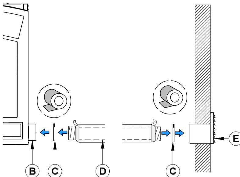
4. Pour compléter l'installation, faire un trou de  $\frac{1}{4}$ " à  $\frac{1}{2}$ " (6 mm à 13 mm) de plus que le diamètre du tuyau dans le mur extérieur de la maison à l'endroit choisi. De l'extérieur, placer la grille d'air extérieure dans le trou (la face ouverte vers le bas) et fixer la grille au mur.
