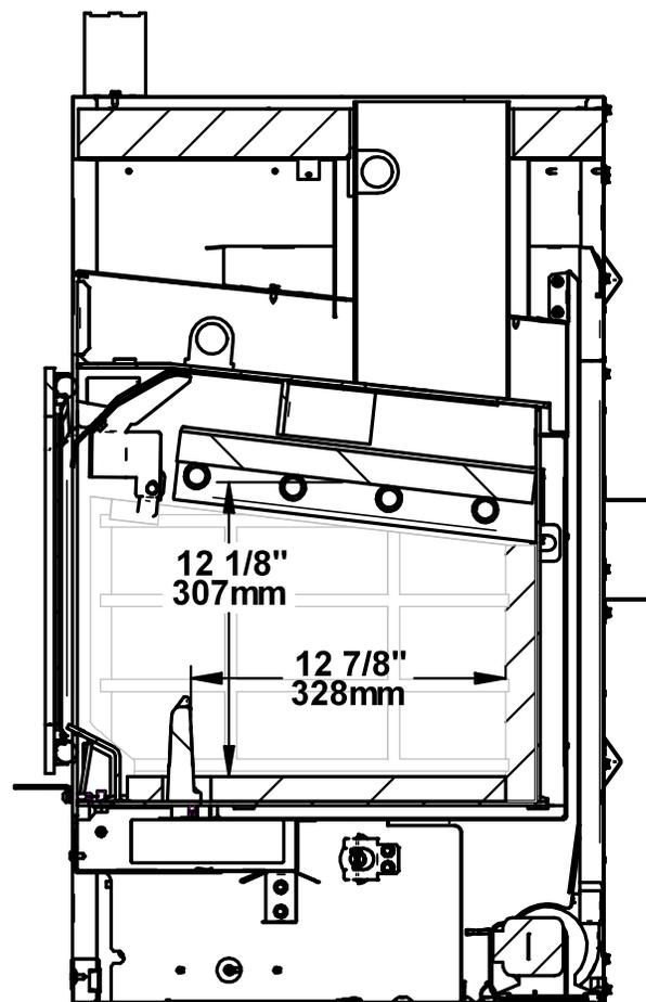
Figure 9: Chambre à combustion - Vue de côté
