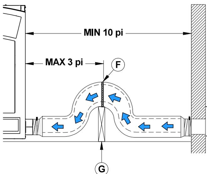
**Il est fortement recommandé d'installer un clapet mécanique étanche permettant de fermer l'entrée d'air extérieur lorsque le foyer n'est pas utilisé.**
