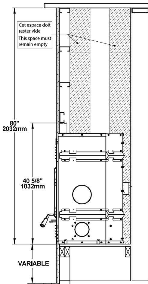
Le foyer ne doit pas être en contact avec de l'isolant ou tout autre matériau de remplissage en vrac. À l'intérieur de l'enceinte, autour du foyer, l'isolant doit être recouvert avec des panneaux de gypse ou tout autre matériau de finition, sauf aux endroits où l'on exige un matériau non combustible.
