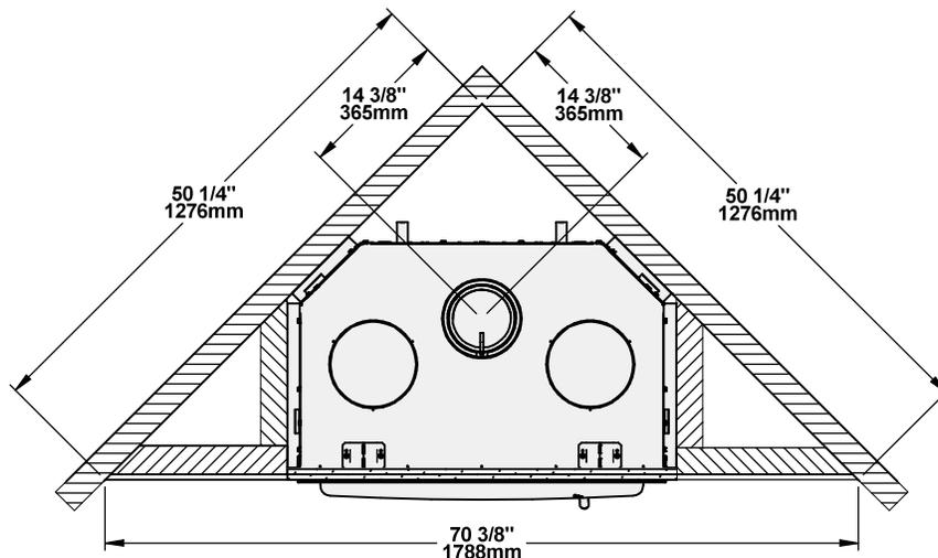
*La configuration du châssis doit être utilisée comme référence seulement.* Si un matériau de finition est installé à l'intérieur de l'enceinte, son épaisseur doit être ajoutée aux mesures suivantes.
