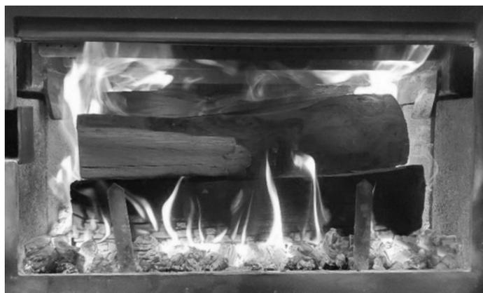
Fermer le contrôle d'air primaire par petits incréments (ex : 1/16 de pouce), de 1/2" à complètement fermé, entre 4 et 15 minutes après la période de chargement. Avant de fermer davantage, assurez-vous que l'intensité de la flamme augmente ou est stable. Fermer complètement la commande d'air. Allumer le ventilateur à la vitesse maximale.
