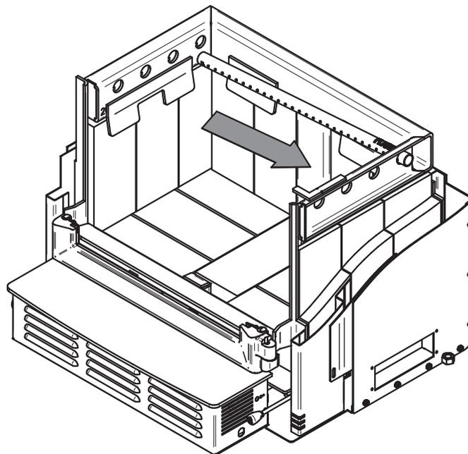
2. Aligner le chemin du tube et la dent dans le trou de la canalisation. Tenir le tube à l'aide d'une pince de serrage et suivre le mouvement décrit dans la figure au-dessous pour le sécuriser en place. S'assurer que la dent touche le fond du chemin du tube.
