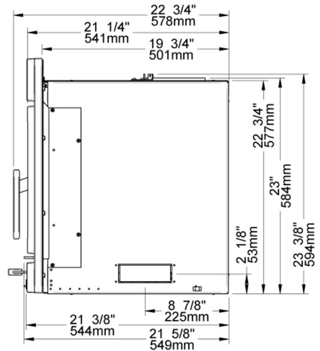
Figure 4 : Vue de côté - Projection maximum
