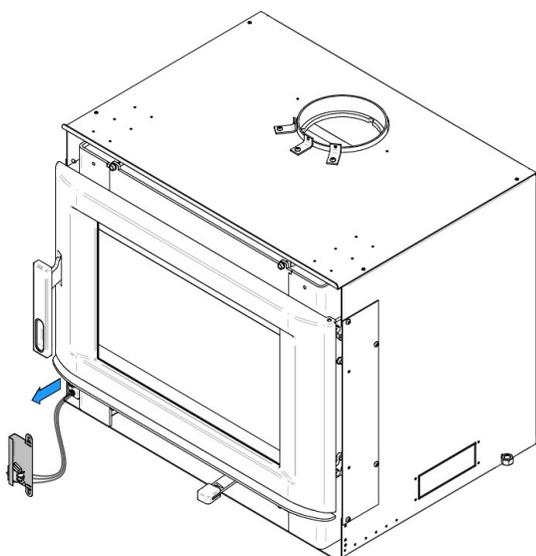
4. Approcher la façade et visser l'interrupteur sur le côté gauche de celle-ci.
