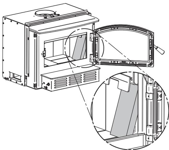
Figure 25 : Installer les briques de côté
