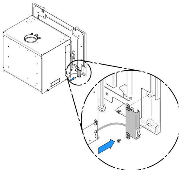
5. Visser la façade sur l'encastable. Attention de ne pas coincer les fils de l'interrupteur.
