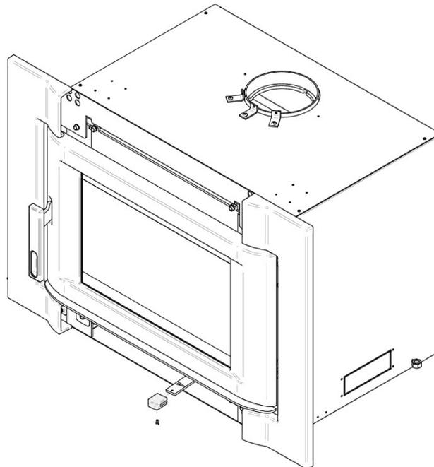
7. Dévisser légèrement les deux vis du bas de l'encastable. Accrocher la façade sur les vis et serrer en place. Réinstaller la poignée de bois.
