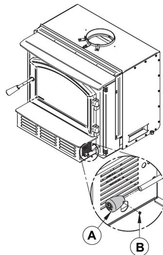
Figure 24 : Installer la poignée du contrôle d'air
