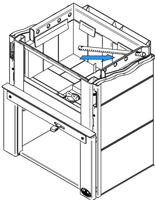
2. Alignez le chemin du tube et la dent dans le trou de la canalisation. Tenez le tube à l'aide d'une pince de serrage et suivez le mouvement décrit dans la figure ci-contre, (détail A) pour le sécuriser en place. S'assurer que la dent touche le fond du chemin du tube.
