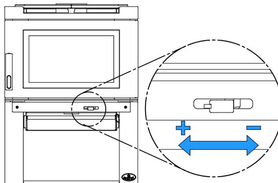
Si les flammes diminuent au point de disparaître, c'est que l'air a été réduit trop tôt dans le cycle de combustion ou que le bois utilisé est trop humide. Si le bois est sec et que le contrôle d'air est utilisé correctement, les flammes devraient diminuer, mais rester vives et stables.
