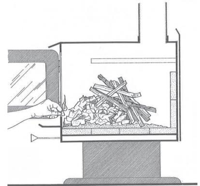
*L'appareil ne doit pas être laissé sans surveillance lorsque la porte est légèrement ouverte. Toujours fermer et verrouiller la porte lorsque le feu est allumé.*
