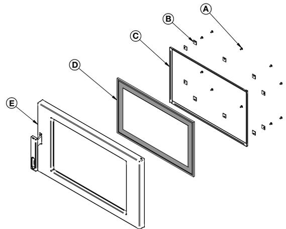
*Les deux principales causes de bris de vitre sont un positionnement inégal dans la porte et des vis de rétention trop serrées.*
