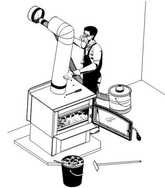
L'inspection et le nettoyage de la cheminée peuvent être facilités en retirant le coupe-feu. Voir [«Annexe 7: Installation des tubes d'air et du coupe-feu»](#) pour plus de détails.
