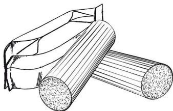
Les bûches densifiées faites à 100 % de sciure comprimée peuvent être brûlées, à condition de ne pas brûler trop de ces bûches à la fois. Ne pas brûler de bûches densifiées contenant de la sciure imprégnée de cire ou de bûches contenant des additifs chimiques. Suivre les instructions et les mises en garde du fabricant.
