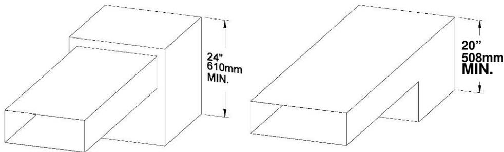
Le plénum d'air chaud sortant de la fournaise doit avoir une hauteur minimum de 24" (610 mm) si le dessus de la première section verticale n'est pas à la même hauteur que la première section horizontale. Dans le cas contraire, la hauteur minimum de la section verticale doit avoir 20" (508 mm). Ces dimensions pour tous les générateurs d'air chaud rencontrent les exigences de la norme CSA B140.4 et UL 391.
