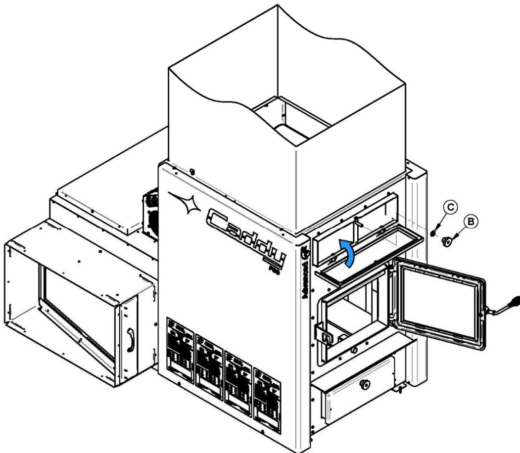
8. Si vous avez effectué le processus de nettoyage en retirant le connecteur de cheminée à l'arrière de la fournaise, assurez-vous de réinstaller le connecteur de cheminée avec trois vis à chaque connexion.
