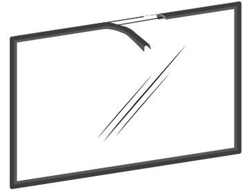
9. Remplacez la vitre **(E)** et le cadre de vitre **(D)** en la centrant dans le cadrage de la porte et installez-les retiens-vitre **(C)** en prenant soin de ne pas trop serrer les vis **(B)**. Notez que les deux principales causes de bris de vitre sont un positionnement inégal dans la porte et des vis de trop serrées.
