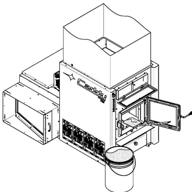
5. La saleté accumulée dans l'échangeur central (2) devra être évacuée par l'avant ou l'arrière de la fournaise. Si vous évacuez la saleté de l'échangeur central vers l'arrière de la fournaise, débranchez votre conduit de cheminée afin d'en disposer.
