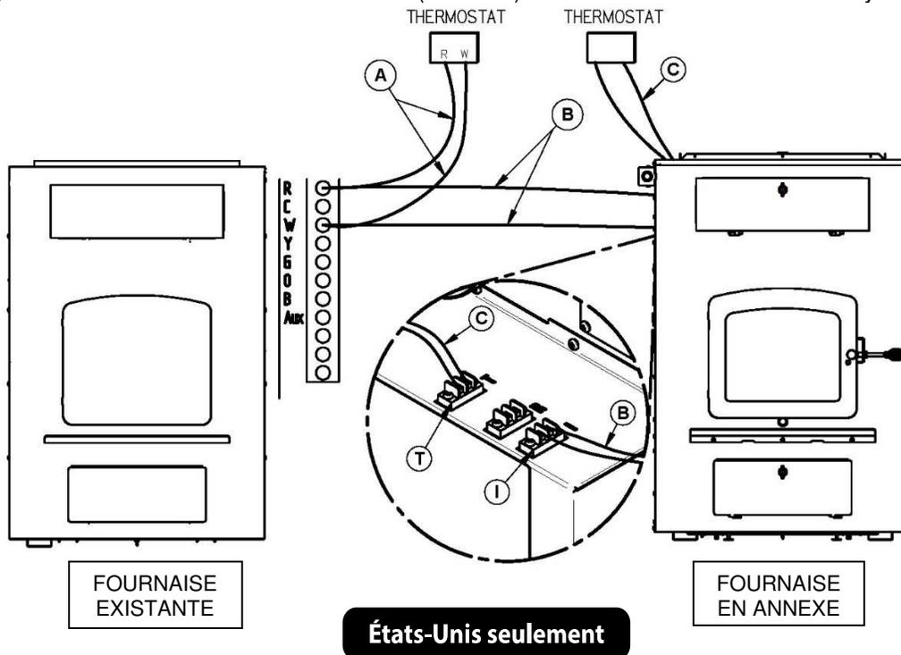
2. À partir du thermostat branché à la fournaise existante, raccordez 2 nouveaux fils (B) sur les bornes R et W du thermostat de votre fournaise existante et fixez-les sur le bornier identifié « I » (interlock) de la fournaise en annexe Caddy Advanced.
