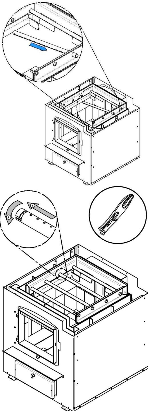
1- En commençant vers l'arrière, inclinez et insérez le tube d'air secondaire arrière dans le trou du fond de la canalisation droite. Ensuite, levez et poussez le tube vers la gauche dans le trou correspondant de la canalisation de gauche.
