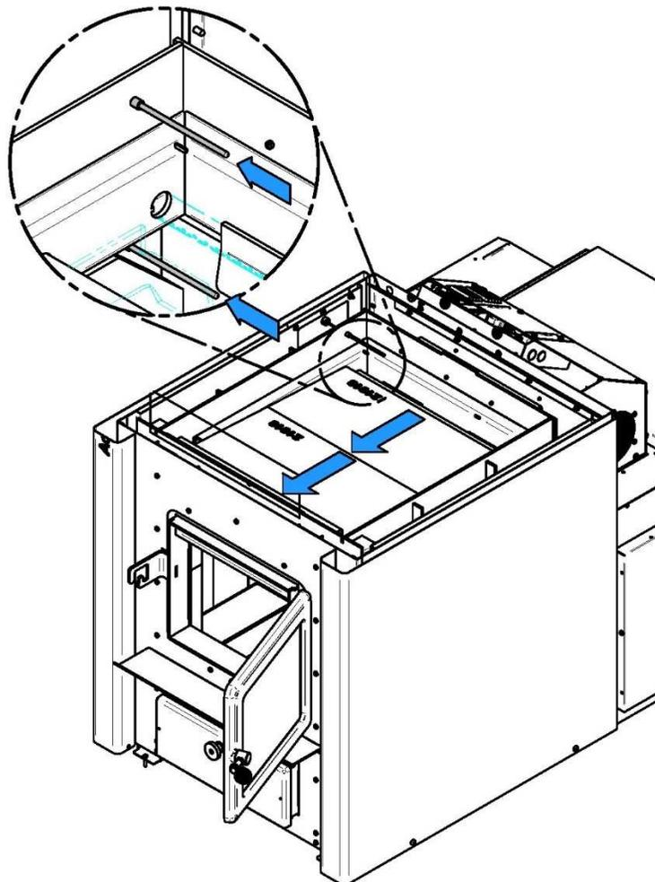
3. Ensuite, repositionnez le coupe-feu dans sa position d'origine soit vers l'arrière. **Si le coupe-feu n'est pas repositionné correctement la fournaise ne fonctionnera pas normalement.**
