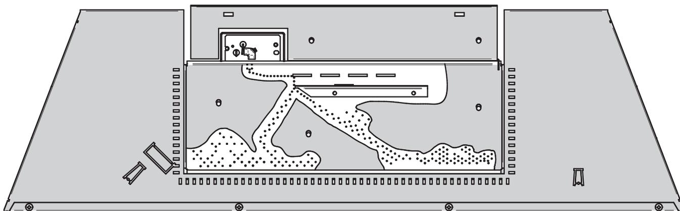
Figure 4: Zone permise pour le positionnement des pierres volcaniques (AC04381)
