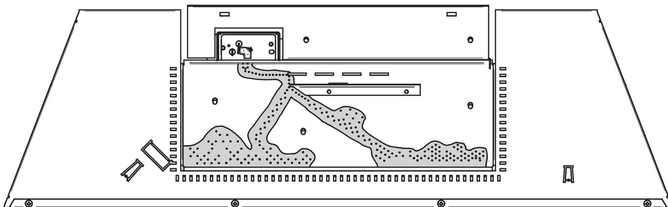
Figure 3: Zone permise pour le positionnement de la laine lumineuse
