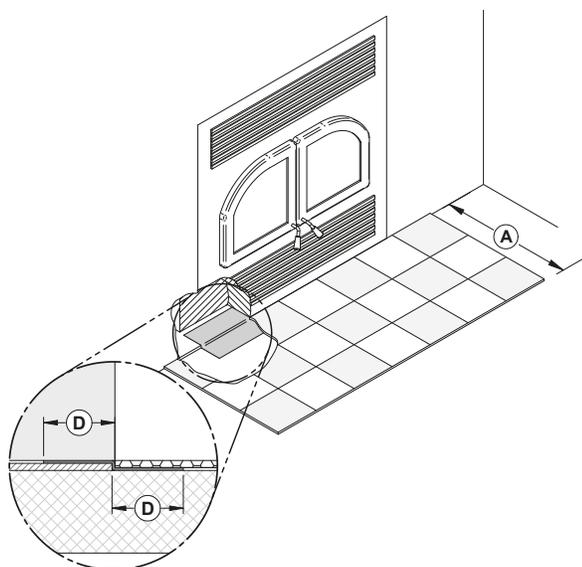
Lorsque le foyer est installé directement sur le plancher, une protection de plancher incombustible d'au moins 16" (**A**) avec un facteur R de 1.00 doit être installée en face du foyer. Le joint entre la protection de plancher et le foyer doit être protégé par une tôle de métal pliée et continue sur toute la largeur de la protection de plancher (**D = min 2" [51 mm]**) (non fournie).
