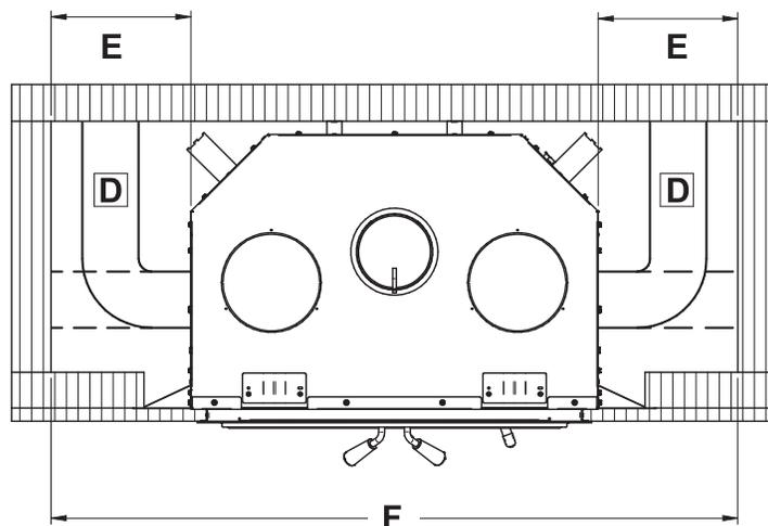
Si un matériau de finition est installé à l'intérieur de l'enceinte, son épaisseur doit être ajoutée aux mesures suivantes.
