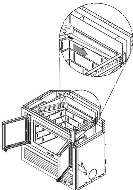
2. Aligner le chemin du tube et la dent dans le trou de la canalisation. Tenir le tube à l'aide d'une pince de serrage et suivre le mouvement décrit dans la figure ci-contre pour le sécuriser en place. S'assurer que la dent touche le fond du chemin du tube.
