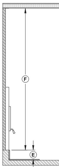
Lorsque le foyer est installé sur une base surélevée de 4" ou moins (**E**), une protection de plancher incombustible d'au moins 16" (**A**) avec un facteur R de 1.00 doit être installée en face du foyer.
