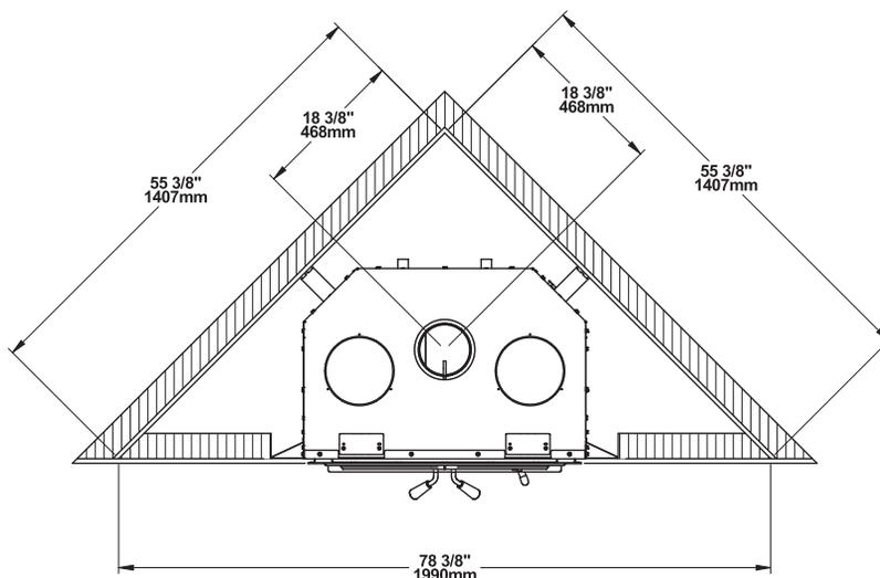
*La configuration du châssis doit être utilisée comme référence seulement.* Si un matériau de finition est installé à l'intérieur de l'enceinte, son épaisseur doit être ajoutée aux mesures suivantes. Ces valeurs sont des mesures minimales et devront peut-être être augmentées afin de permettre l'installation de l'ensemble d'entrée d'air frais ou de l'ensemble de distribution par air forcé ou selon le type de matériau de finition utilisé.
