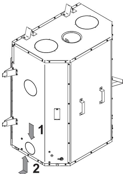
L'ensemble d'entrée d'air frais peut être installé à deux endroits différents sur le foyer. Sur le côté droit **(1)** de l'appareil (le plus commun) ou sous l'appareil **(2)**.
