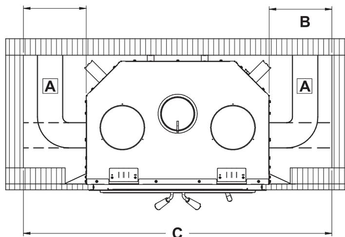
Si un matériau de finition est installé à l'intérieur de l'enceinte, son épaisseur doit être ajoutée aux mesures suivantes.
