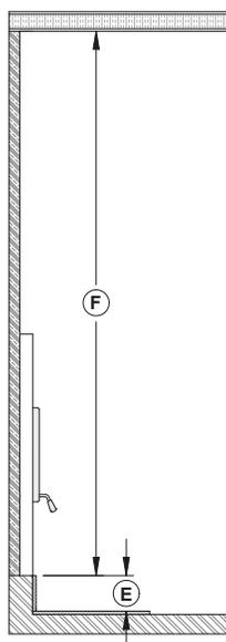
Lorsque le foyer est installé sur une base surélevée de plus de 4" (**E**), une protection de plancher incombustible d'au moins 16" (**A**), sans facteur R doit être installée en face du foyer.
