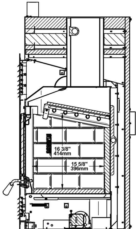
Chambre à combustion - Vue de côté
