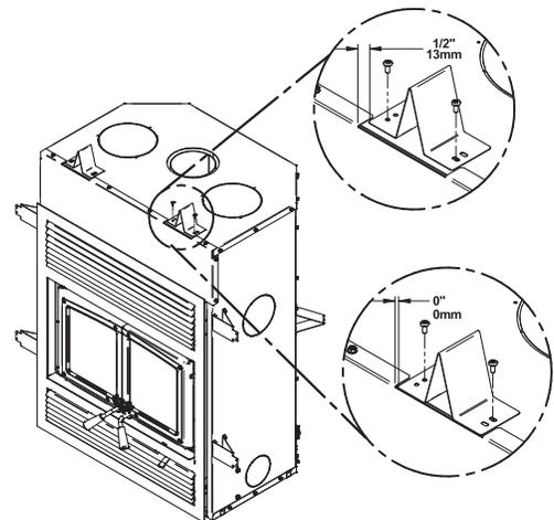
Construire le châssis du foyer à l'aide de montants verticaux placés sur les côtés du foyer, allant du plancher au plafond. Les montants doivent être reculés par rapport au rebord frontal du foyer d'un espace équivalent à l'épaisseur du matériau de finition, pour que celui-ci soit à ras de la finition du foyer.
