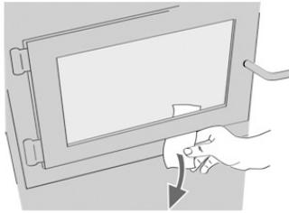
Afin d'obtenir un rendement optimal, la porte doit être parfaitement étanche avec la chambre à combustion. L'étanchéité de la porte peut être vérifiée en fermant et en verrouillant la porte sur un bout de papier. Le tour complet de la porte doit être vérifié. Si le papier glisse facilement à n'importe quel endroit, il faut soit ajuster la porte ou remplacer le joint d'étanchéité.
