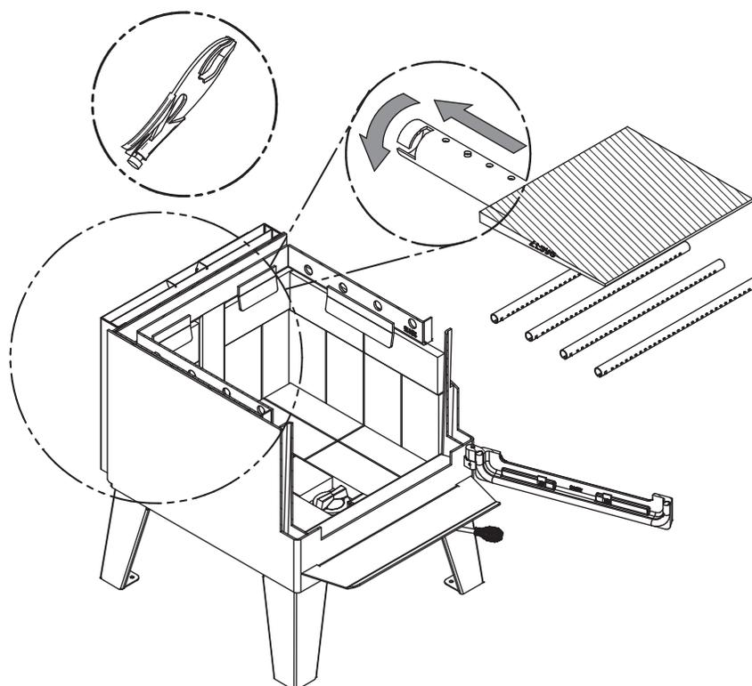
Prendre note que n'importe quel tube (B) peut être remplacé sans retirer le coupe-feu (A) et que les tubes sont tous identiques.
