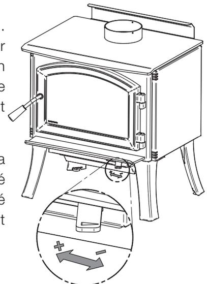
D'un autre côté, une trop grande admission d'air peut rendre le feu incontrôlable, créant des températures très élevées dans l'appareil ainsi que dans la cheminée et les endommager sérieusement. Une lueur rougeâtre sur l'appareil ainsi que sur les composants de la cheminée indiquent une surchauffe. Des températures excessives peuvent provoquer un feu de cheminée.
