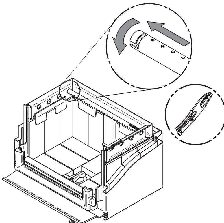
Prendre note que n'importe quel tube (B) peut être remplacé sans retirer le coupe-feu (A) et que les tubes sont tous identiques.
