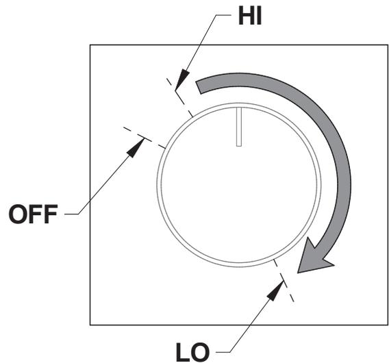
Figure 17: Rhéostat du ventilateur
