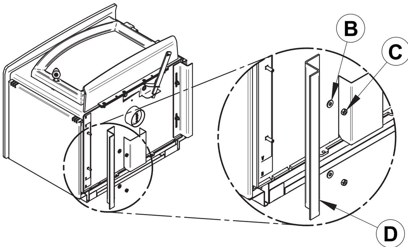
3. Installer le piedestal **(E)** sur le poêle et le fixer en place avec les rondelles **(B)** et écrous **(C)** de l'étape précédente.
