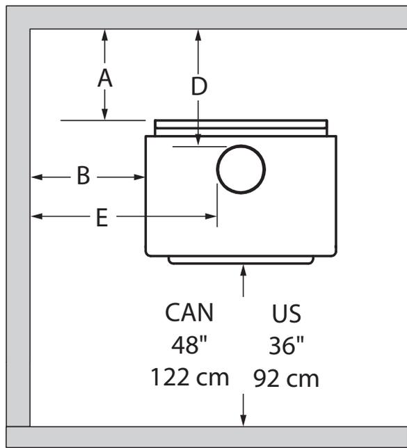
Figure 20: Dégradements - Dessus
