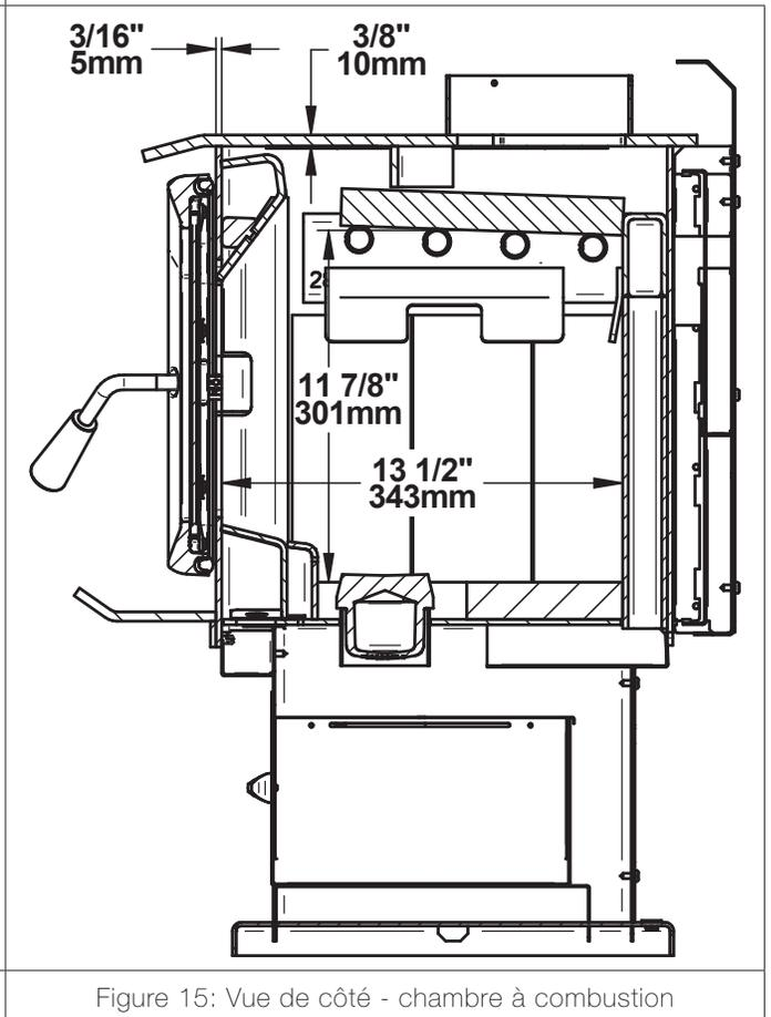
Figure 15: Vue de côté - chambre à combustion
