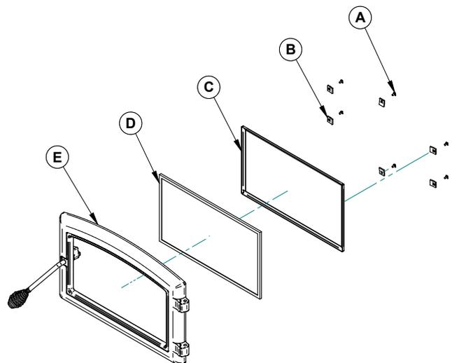
Figure 14: Remplacement la vitre
