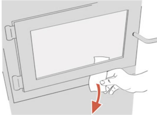
Figure 13: Vérification du joint de la porte
