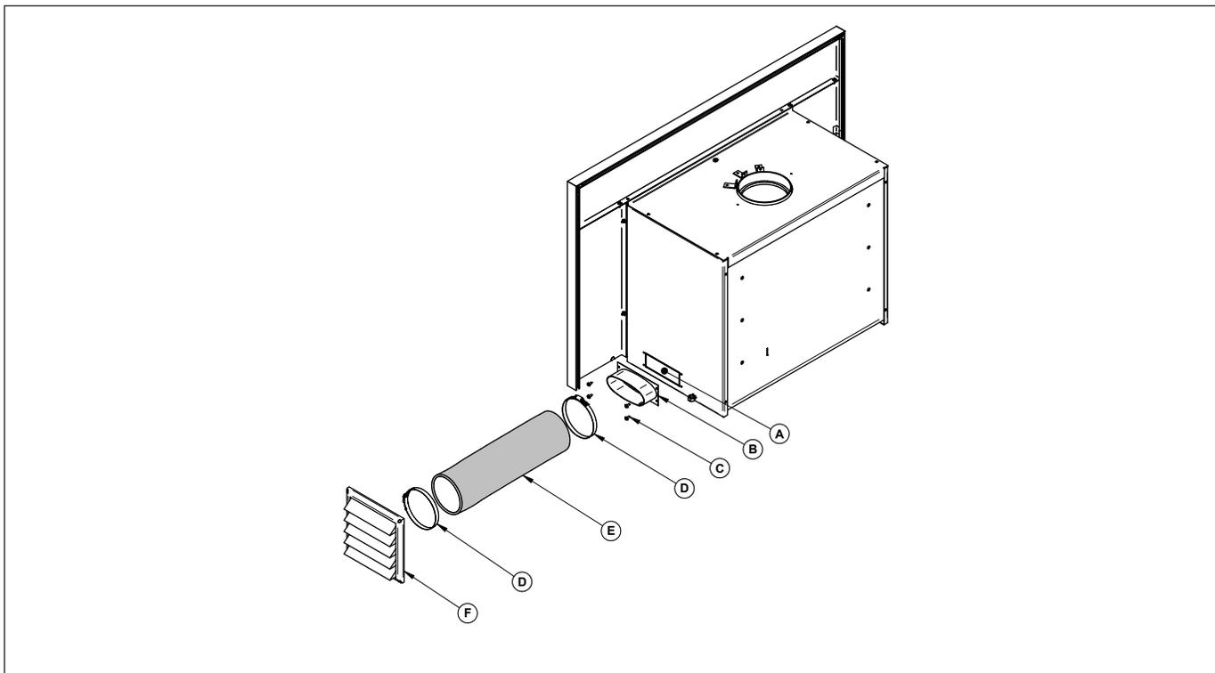
2. Installer l'adaptateur d'admission d'air frais (B) avec quatre vis (C), puis fixer le tuyau flexible<sup>1</sup> (E) à l'adaptateur (B) en utilisant l'un des colliers de serrage (D). Fixer l'autre extrémité du tuyau à la terminaison murale extérieure (F) en utilisant l'autre collier de serrage (D). La terminaison murale extérieure (F) doit être installée à l'extérieur de la maison.
