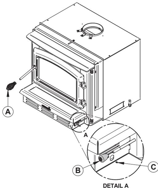
Figure 8: Poignée de la porte et du contrôle d'air
