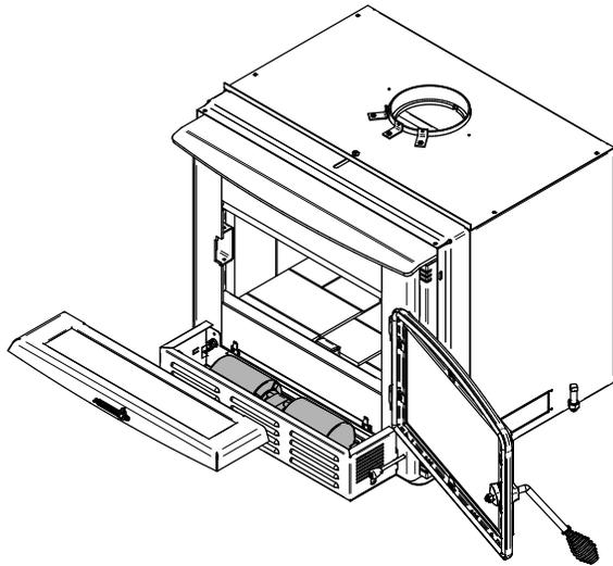
Figure 9: Emplacement du ventilateur
