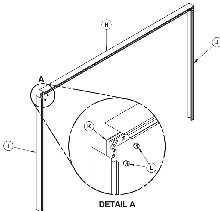
3. Insérer les coins **(K)** dans la rainure de chaque moulure décorative **(H)**, **(I)** et **(J)**. Aligner les coins du côté incliné de chaque moulure, puis serrez les vis **(L)** pour fixer les moulures.
