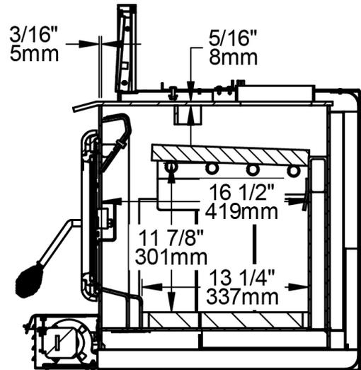
Figure 6: Vue de côté - Chambre à combustion
