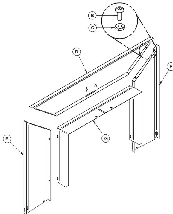
2. Aligner les trous des panneaux **D, E** et **F** et les fixer ensemble à l'aide des boulons **(B)** et des écrous **(C)** fournis. Aligner les trous de l'extension **(G)** avec les trous des panneaux et les visser ensemble à l'aide des boulons et des écrous fournis.
