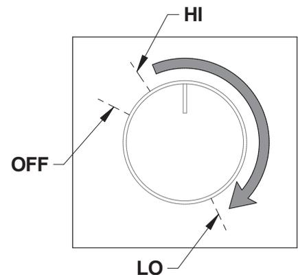
Figure 10: Rhéostat du ventilateur
