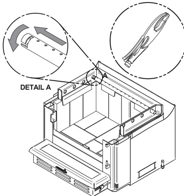
2. Aligner le chemin du tube et la dent dans le trou de la canalisation. Tenir le tube à l'aide d'une pince de serrage et suivre le mouvement décrit dans la figure au-dessus pour le sécuriser en place. S'assurer que la dent touche le fond du chemin du tube.
