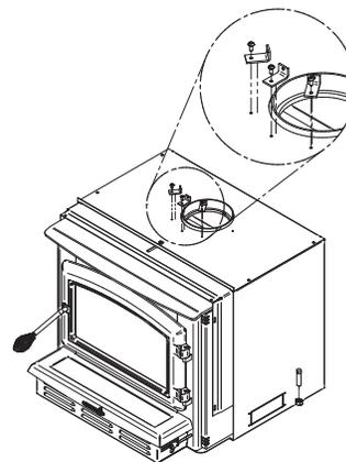
Figure 24: Installation des équerres
