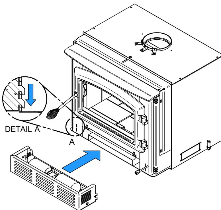
1. Fixez le ventilateur sur l'insert en alignant et en insérant les crochets de chaque côté de l'insert.
