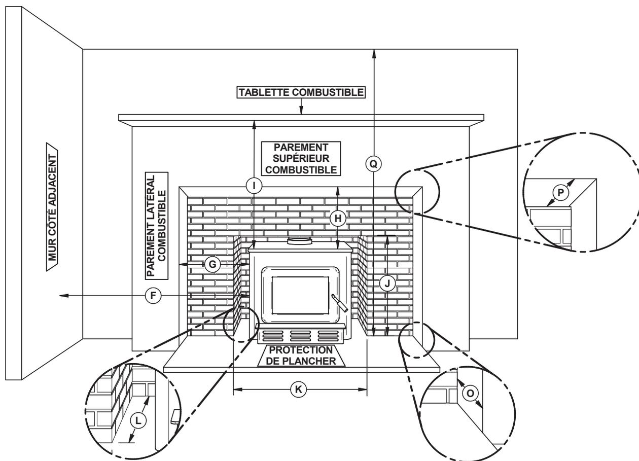
Figure 20: Ouverture de l'âtre et dégagements aux combustibles
