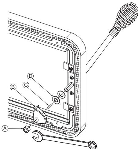
Figure 12: Ajustement de la porte
