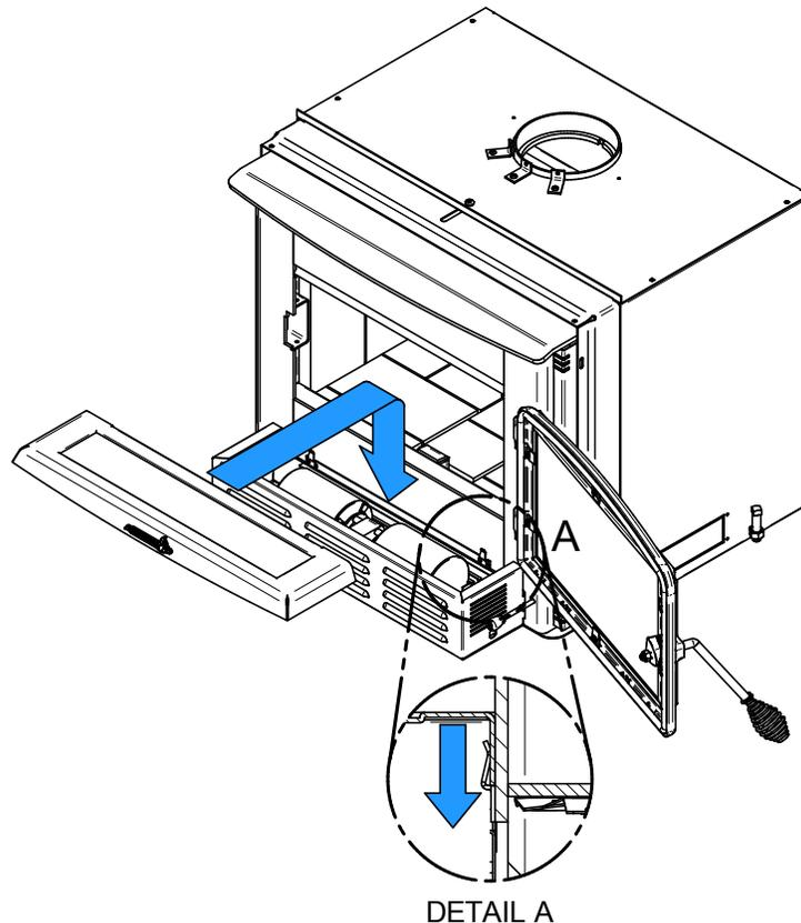
2. Ouvrir la porte. Centrer la tablette à cendres avec le ventilateur et pousser contre la chambre de combustion. Ensuite, pousser vers le bas pour qu'elle se clipse dans les deux encoches.
