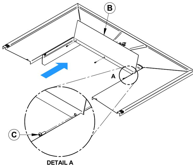
1. Installez l'écran coupe-chaueur (**B**) sur la façade à l'aide de 3 vis auto-perçantes (**C**) comprises dans le kit. L'écran coupe-chaueur doit pointer vers le haut.
