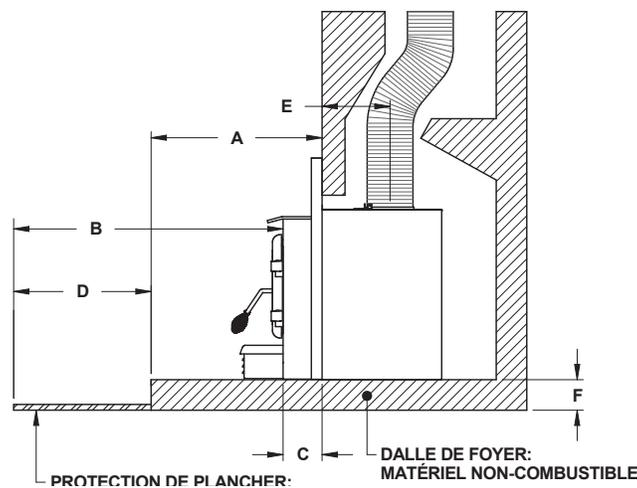
Figure 19: Installation surélevée de plus de 5"
