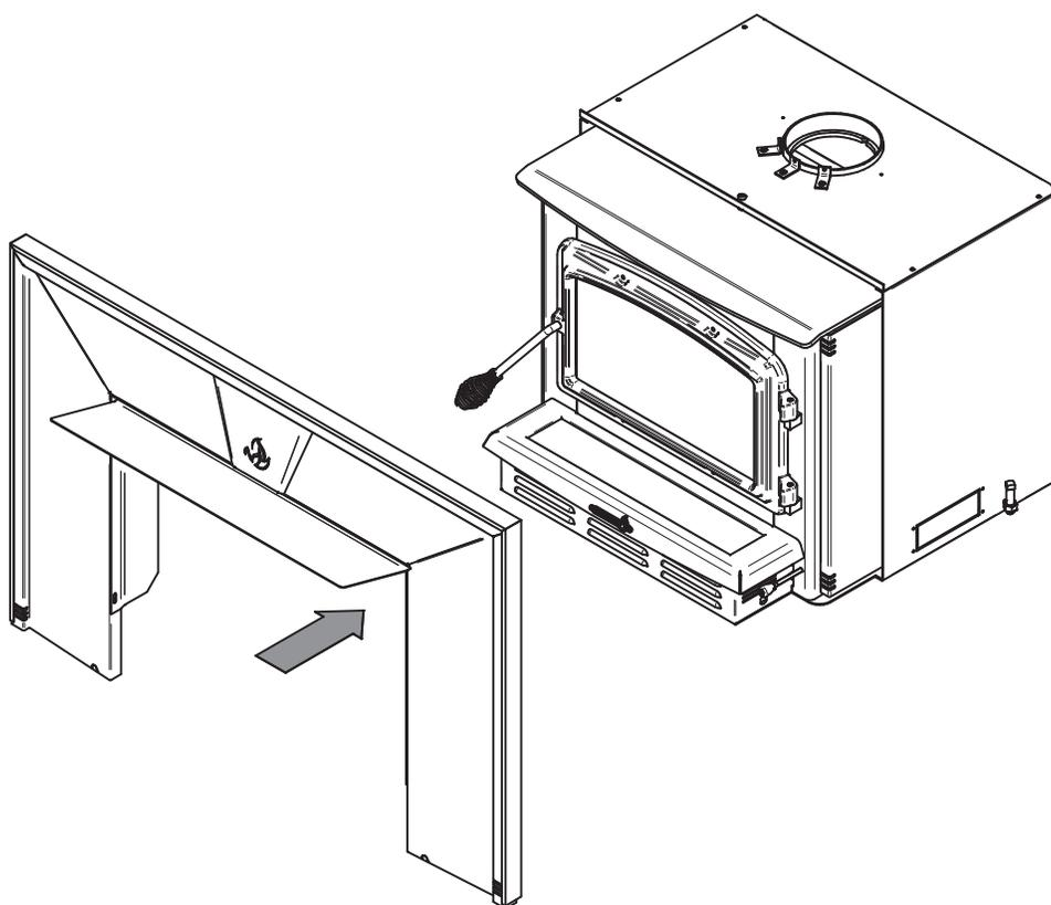
2. Lorsque l'écran coupe-chaueur placé, installer la façade sur l'encastrable.
