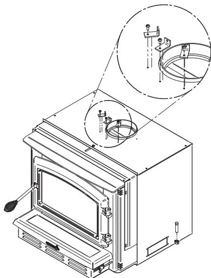
Figure 26: Installation des équerres
