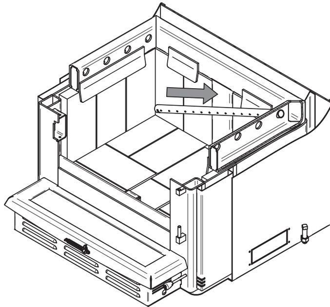
1. En commençant vers l'arrière, Incliner et insérer le tube d'air secondaire arrière dans le trou du fond de la canalisation droite. Ensuite, lever et pousser le tube vers la gauche dans le trou correspondant de la canalisation de gauche.
