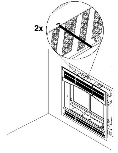
5. Appuyez la façade sur le foyer et fixez le bas de celle-ci à l'aide de 2 vis auto-perforantes fournies dans l'ensemble de manuel du foyer.
