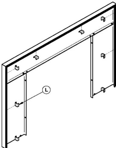
Fixez la moulure à la façade en insérant les huit attaches (L) entre le bord intérieur de la moulure et l'avant de la façade. Comme dans l'image sur la gauche.
