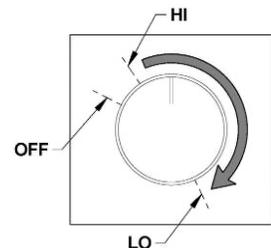
Puisque le ventilateur de l'encastable est muni d'un capteur thermique, lorsque celui-ci est actionné, il se mettra en fonction automatiquement lorsque l'encastable sera chaud et s'arrêtera lorsque l'encastable aura refroidi. Par conséquent, vous pouvez laisser le contrôle de vitesse variable à la vitesse désirée.
