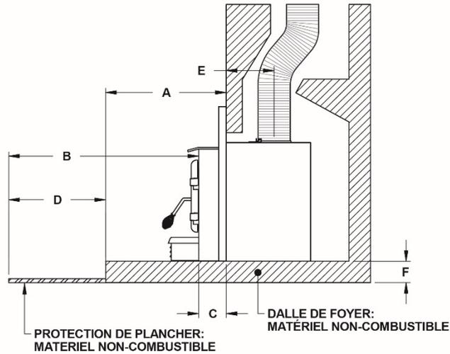
Si la valeur (D) est négative ou égale à zéro, vous n'avez pas à rajouter de protection de plancher au-devant de l'appareil, car l'extension de l'âtre est suffisamment grande. Si la valeur (D) est positive, vous devrez mettre une protection de plancher en avant de l'extension de l'âtre d'au moins l'équivalent du résultat (D).
