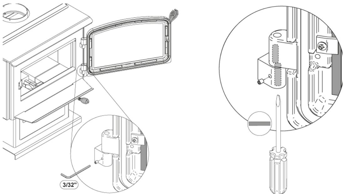
À l'aide d'un tournevis plat, tourner les tiges de pentures ajustables dans le sens indiqués pour ajuster les portes. Resserrez toutes les vis de pression sur les gonds de portes lorsque ces dernières sont aux positions désirées. Les configurations 1-2-3-4-5-6, indiquent dans quelle direction celles-ci agissent sur l'ajustement de la porte.
