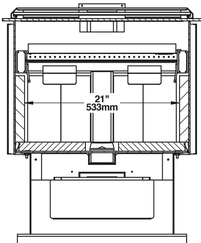
Figure 8: Vue de face - chambre à combustion
