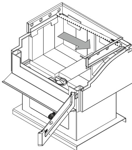
2. Aligner le chemin du tube et la dent dans le trou de la canalisation. Tenir le tube à l'aide d'une pince de serrage et suivre le mouvement décrit dans la figure ci-contre, pour le sécuriser en place. S'assurer que la dent touche le fond du chemin du tube.
