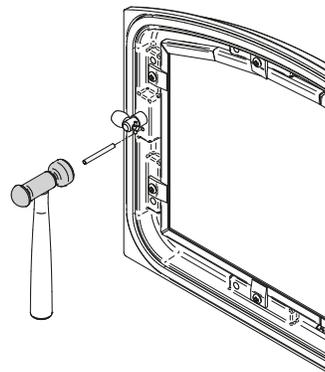
Figure 18: Installation de la goupille de retenue
