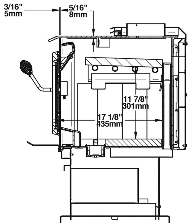
Figure 9: Vue de côté - chambre à combustion
