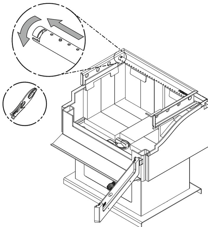
Prendre note que n'importe quel tube (B) peut être remplacé sans retirer le coupe-feu (A) et que les tubes sont tous identiques.
