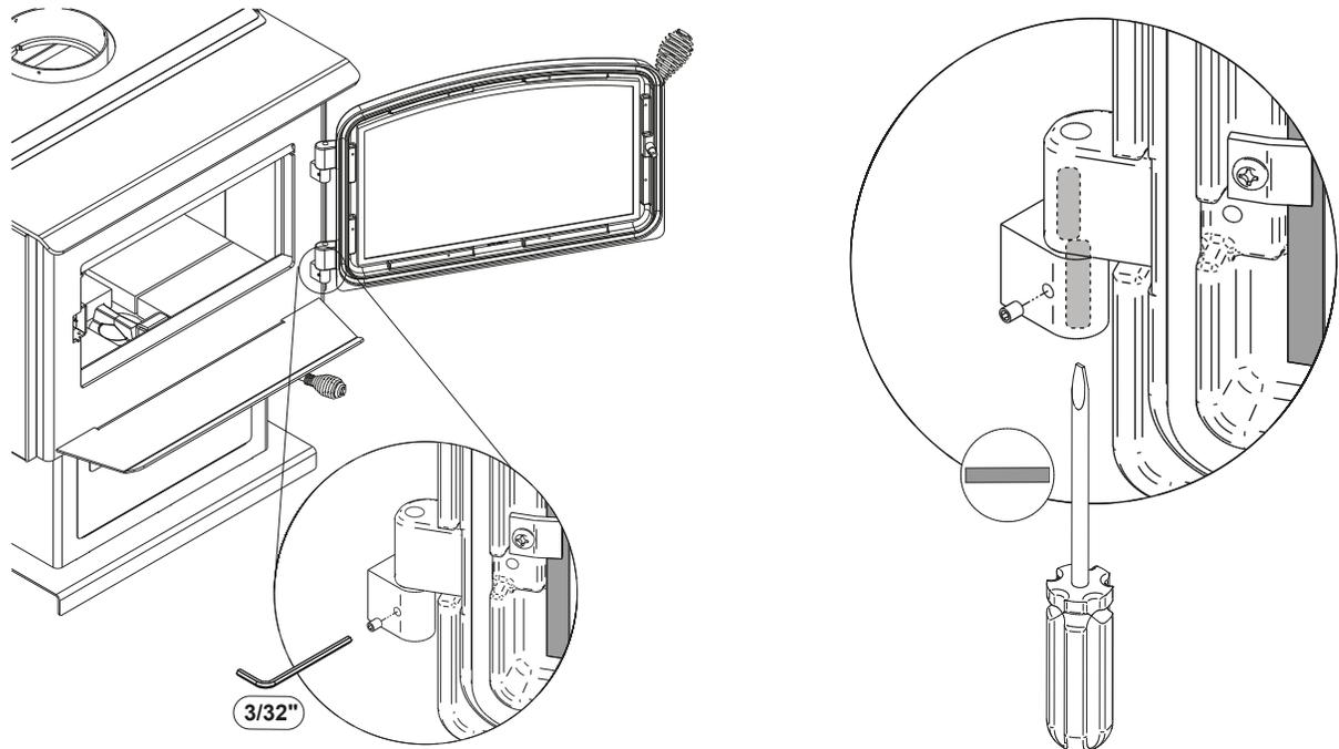
À l'aide d'un tournevis plat, tourner les tiges de pentures ajustables dans les sens indiqués pour ajuster les portes. Resserrez toutes les vis de pression sur les gonds de portes lorsque ces dernières sont aux positions désirées. Les configurations 1-2-3-4-5-6, indiquent dans quel direction celles-ci agissent sur l'ajustement de la porte.
