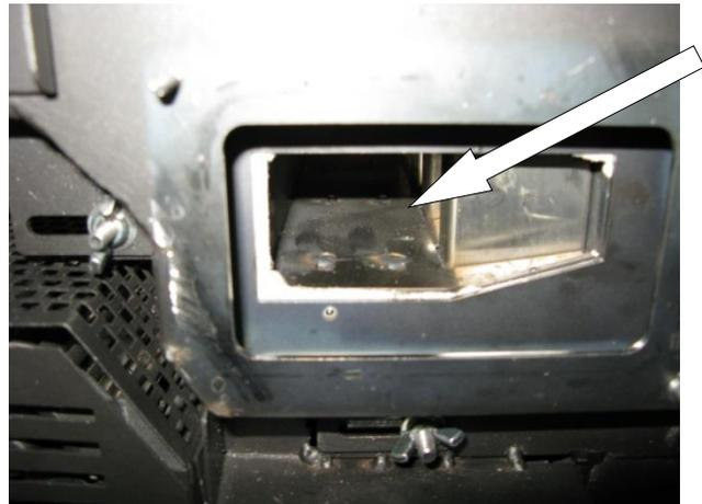
Vérifiez que les joints d'étanchéité des panneaux soient encore en bon état, les remplacer au besoin.
